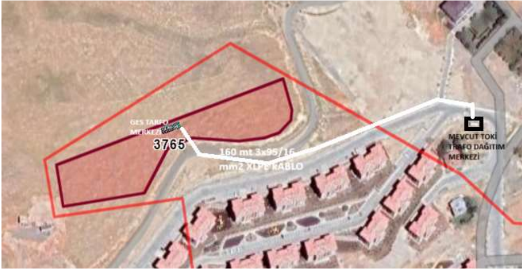
Şekil 3. Enerji Nakil Hattı
